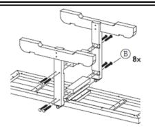
3. Verschrauben Sie die beiden Standfüße mit den Verbindungsstreben. Verbinden Sie die Wippfläche, indem Sie die Teile des Scharniers zusammenfügen.
