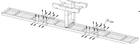
5. Vervollständigen Sie die Lauffläche, indem Sie die grünen Flächen mit dem roten Mittelstück verschrauben. Verwenden Sie hierfür die Winkelprofile.
