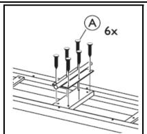
Schrauben Sie das Mittelstück des Scharniers an die rote Lauffläche.
